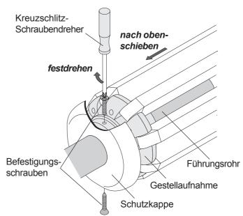
Die Montage des Gestellarmes an der unteren Gestellaufnahme erfolgt sinngemäß wie zuvor an der oberen Gestellaufnahme beschrieben. Das Lösen seitlicher Befestigungsschrauben entfällt.
